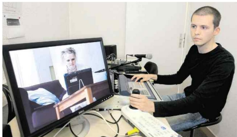
L'Eye tracker est un ordinateur dont l'écran cache des faisceaux infrarouges. L'objectif ? Suivre le parcours des yeux, notamment pour étudier la manière dont un internaute lit un site web.
